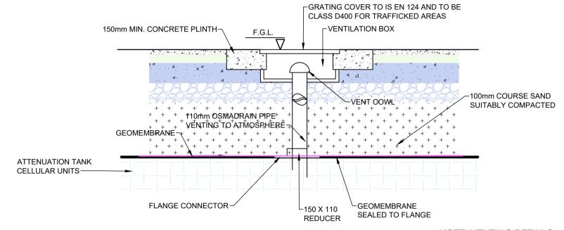
TYPICAL AIR VENT SYSTEM DETAIL SCALE : 1:20
