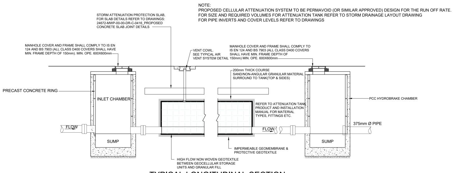
TYPICAL LONGITUDINAL SECTION THROUGH ATTENUATION SYSTEM SCALE : 1:20
